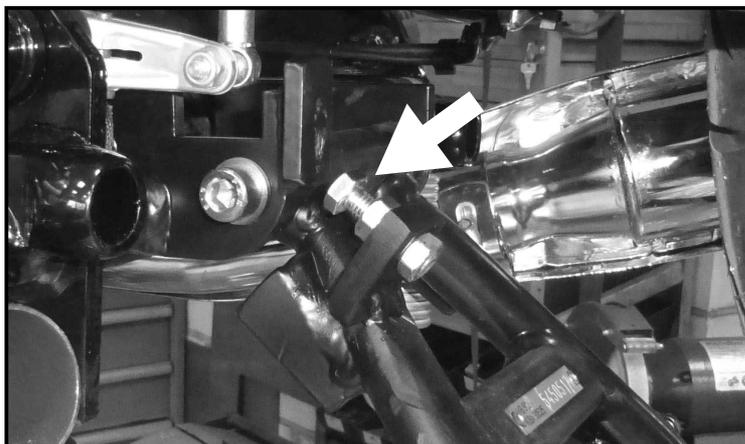
Halteadapter ausrichten und mit der Originalschraube sowie Scheibe und Mutter **locker** anschrauben.
