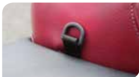
FOTO N° 10: ESEMPIO DI MONTAGGIO DELLA CINGHIA SU UNA MOTO
