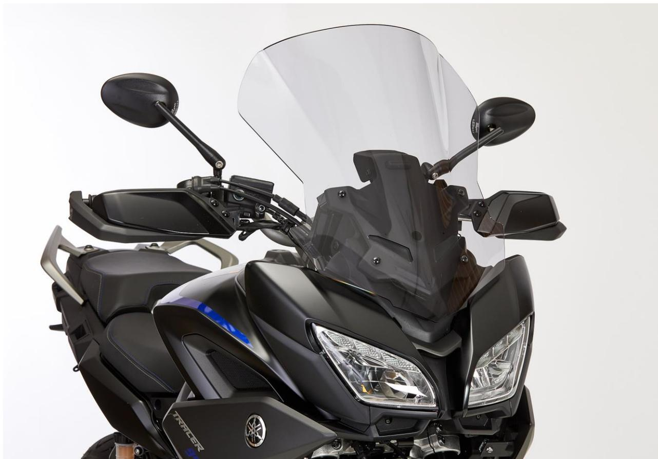
1. Demontieren Sie die Originalscheibe und montieren Sie die Ermax Scheibe mittels den Original-Schrauben
