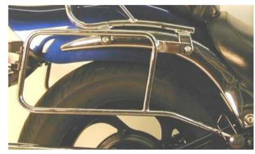
Der zuvor montierte Versteifungsbügel wird an den kleinen seitlichen Laschen der Kofferträger (in Fahrtrichtung gesehen – <u>davor</u>) mit den Linsenkopfschrauben M 6 x 20 nebst U-Scheiben 6,4 mm und selbstsichernden Muttern M 6 verschraubt.
