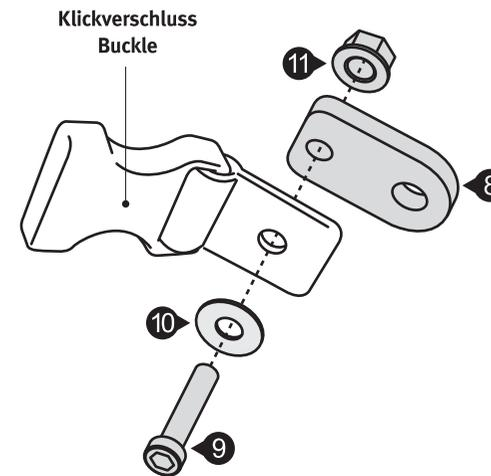
Montieren Sie die gezeigten Teile an den Anbaublechen (8). Entnehmen Sie die Klickverschlüsse Ihren Satteltaschen und verschrauben Sie diese wie gezeigt.
