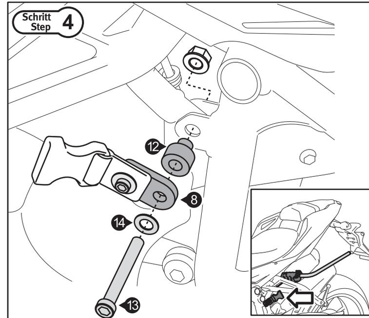
Montieren Sie die Anbaubleche (8) beidseitig am Fahrzeugrahmen. Verwenden Sie die originale Muttern.
