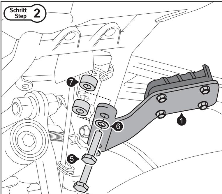
Montieren Sie die Anbaubleche (1) beidseitig unter den Sozius-Fußrasten, wie in der Zeichnung gezeigt. **Benutzen Sie flüssige Schraubensicherung.**
