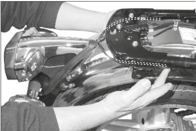
**10** Verlegen Sie die Blinkerkabel seitlich zwischen Kotflügel und Fahrzeugrahmen.
