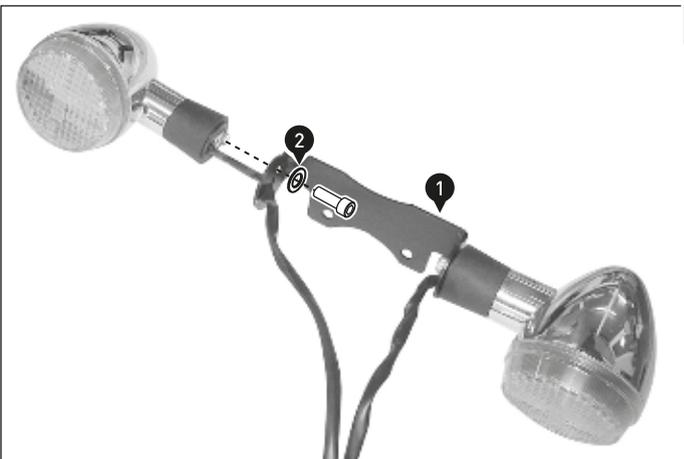
**7** Befestigen Sie die Blinker mit den originalen Schrauben und Unterlegscheiben (2) am Blinkerblech (1).
