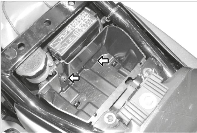
**1** Entfernen Sie die Sitzbank. Lösen Sie die markierten Verbindungen und entfernen Sie das Ablagefach.
