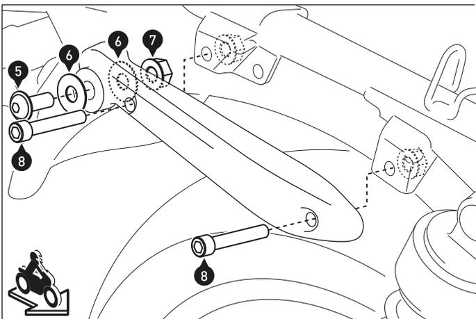
**12** Verschließen Sie die Blinkeröffnungen der Seitenstreben mit den gezeigten Teilen. Verschrauben Sie die Seitenstreben mit den Schrauben (8) und originalen Muttern am Fahrzeug. Ziehen Sie die Schrauben wie in der Stückliste vorgegeben an.
