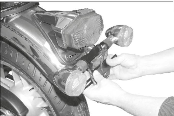
**8** Verschrauben Sie das Blinkerblech (1) ZWISCHEN Kennzeichenhalter und Rücklicht am Fahrzeug. Nutzen Sie die originalen Teile des Kennzeichenhalters.
