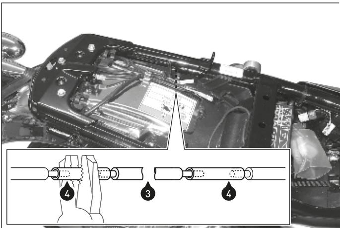
**11** Nun müssen die originalen Blinkerkabel verlängert werden. Durchtrennen Sie die originalen Kabel. Entfernen Sie die Isolierungen an den Kabelenden. Verwenden Sie die Kabelverbinder (4), um die Kabelenden mit den mitgelieferten Kabelverlängerungen (3) zu verbinden, wie in der Zeichnung gezeigt. Verbinden Sie anschließend die Blinkerstecker mit dem Bordnetz.
