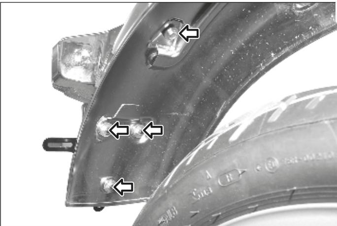
**6** Lösen Sie die markierten Schraubverbindungen des Rücklichts und Kennzeichenhalters; entfernen Sie den Kennzeichenhalter vom Fahrzeug.
