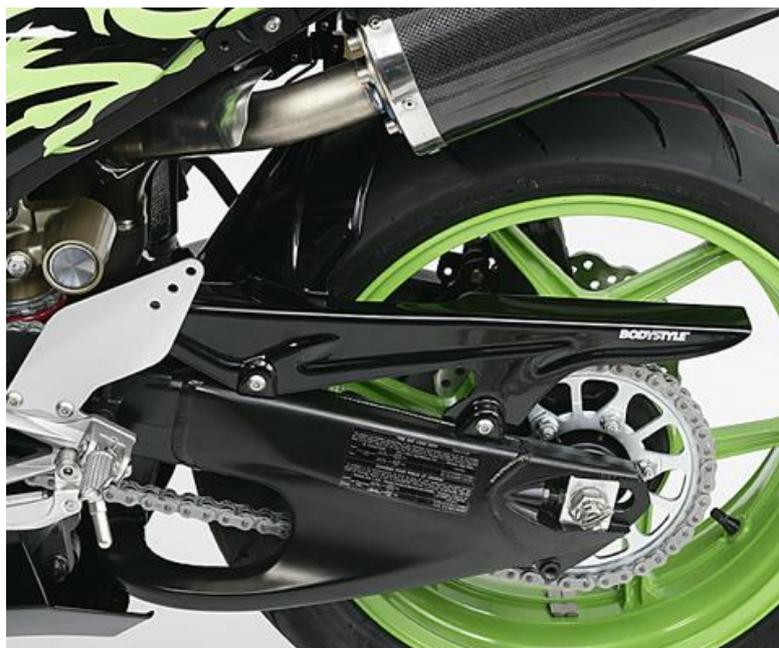
1. Demontieren Sie den Kettenschutz
