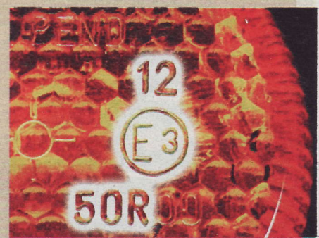
Die Kennzahl 12 verrät, dass dieser Blinker fürs Heck zugelassen ist
