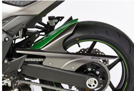
1. Demontieren Sie die originale Hinterradabdeckung und montieren Sie die Bodystyle Hinterradabdeckung an den Originalaufnahmen mittels den original Befestigungsschrauben und der Gummi U-Scheiben.
