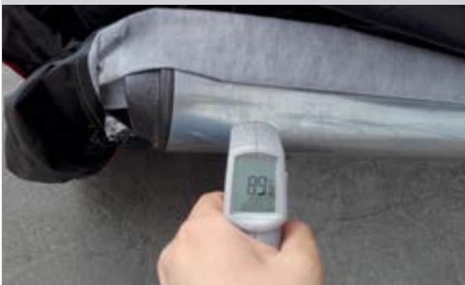
Beim Hitzetest mussten die Planen je nach Beschaffenheit zwischen 85 Grad am Endschalldämpfer und 150 Grad am Krümmer aushalten.
