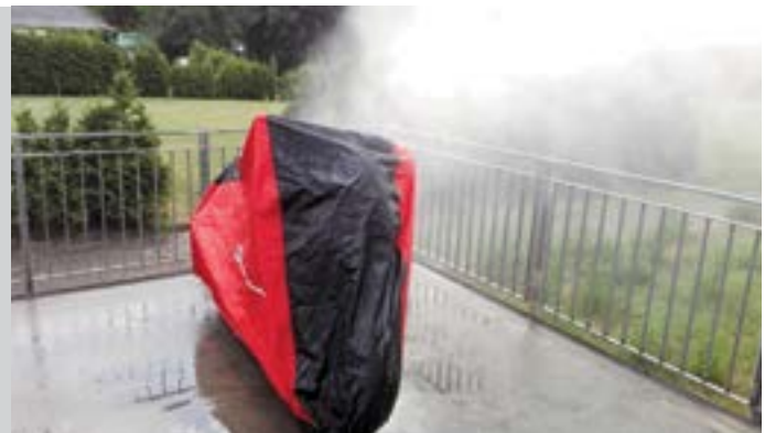
Zehn Minuten intensiver Bewässerung mit dem Hochdruckreiniger verriet, ob eine Haube wasserdicht ist.
