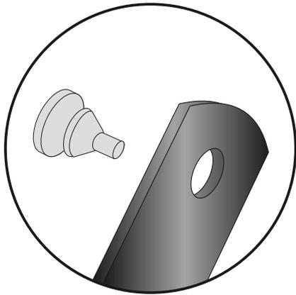
Anschlaggummis in die Bohrungen am Hauptständer einziehen.
