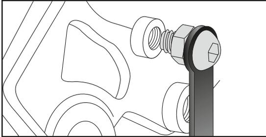
Die Linsenschraube mit Schraubensicherung in das freie Gewinde eindrehen und mit der Mutter M8 kontern. Die Fußraste und den Kunststoffschutz wieder montieren.
