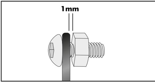
Auf die Linsenschraube M8x20 den Federhalter aufstecken, und mit der Mutter M8 bis auf ein leichtes Laufspiel von ca. 1 mm, aufdrehen.
